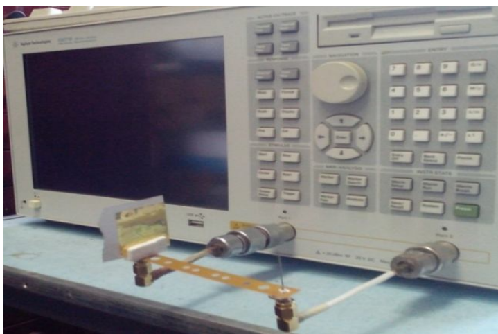
Рис. 1. Измерительный стенд с измерительными антеннами электрического типа и установленным экраном 30x30мм.
